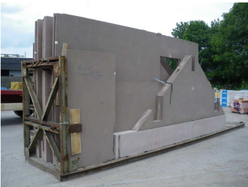
stone-Walls werden nach der Erstellung auf dem Hof gelagert
